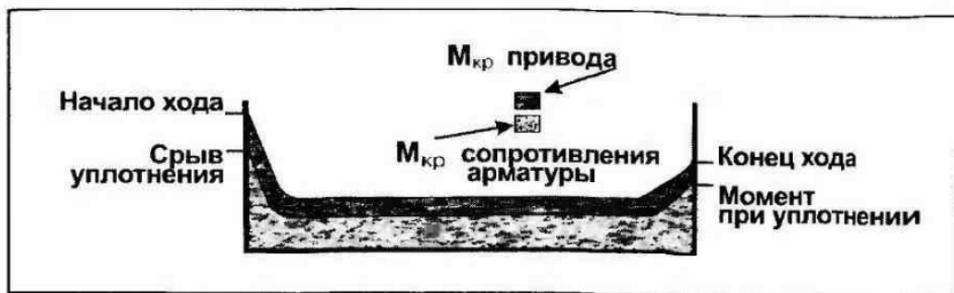
Рис. 73. Кривые крутящих моментов поворотных затворов и шаровых кранов с электроприводами
